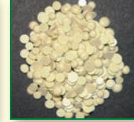
Dispersiyon ve oksidasyonu artırmak için çok az kil ilave edilmiş kükürt tabletleri
